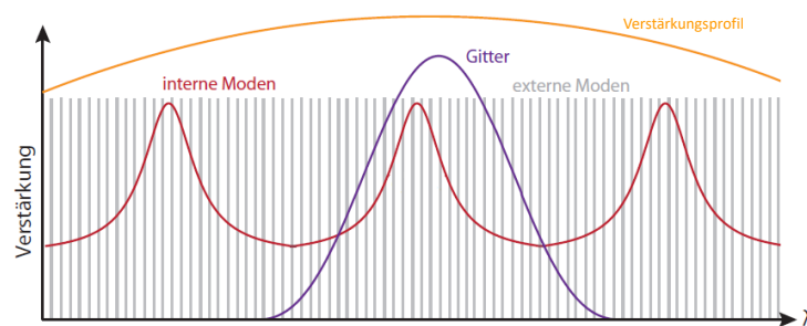
Abbildung 3.13: Schematische Modenüberlagerung des internen und des externen Resonators.
